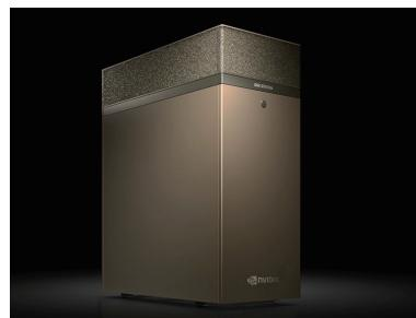
最新GPU「TESLA V100」×4基や第2世代のNVLink、新しいTensorコアアーキテクチャを搭載し、混合精度演算性能は500TeraFLOPSに達する個人向けスーパーコンピュータ。デスク下に収まる省スペースサイズで、水冷システムによる静粛性や優れた低消費電力性能も兼ね備える。
